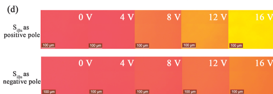
图 9 不同直流电压下 PSCLC 的透射光谱, S_{\text{illu}} 为正极(a)和 S_{\text{illu}} 为负极(b), \lambda_{\text{min}} 和 \lambda_{\text{max}} 与直流电压的关系(c)。光学显微镜的反射模式观察 PSCLC 在不同直流电压下的显微照片(d)。
